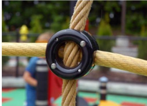
Kletternetze aus UV-beständigen PA-Seilen mit innerer Seilverstärkung. Die Seile sind induktionsbehandelt, um die Verbindung zwischen Stahl und Seil zu stärken und eine hohe Verschleiß- und Reißfestigkeit zu gewährleisten. Alle Seilverbindungen bestehen aus 100% recyclebarem PA.
